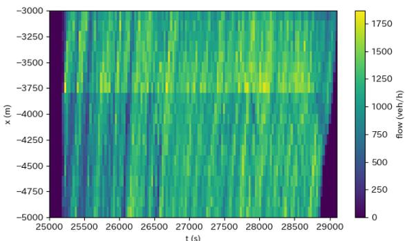
図-8 Visualizer による流率可視化状況
